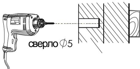
На этом этапе сборки необходимо доработать отверстия "X" предназначенные для соединения изделий между собой. Для этого придвинув шкафы плотно друг другу так, чтобы между ними не было перепада по высоте, сверлим вертикальные щиты сверлом Ø5мм через существующие дорабатываемые отверстия.
